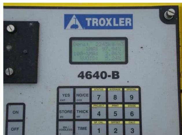
**Fotos:** Ausreichende Mischgutproben für spätere Untersuchungen (Rückstellproben). Mit der Troxler-Sonde wurde fortlaufend der Verdichtungsgrad gemessen.
